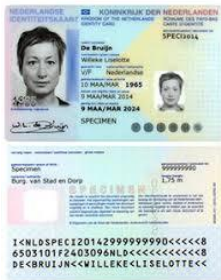
Figuur 4 Machine Readable Zone op een Nederlandse identiteitskaart
